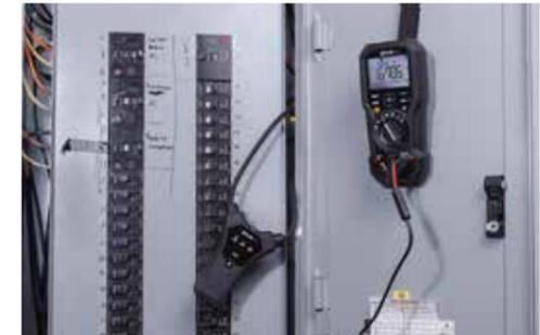
FLIR TA74和FLIR DM93万用表配合使用
