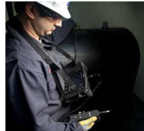
检查飞机引擎和机身裂缝、磨损、缺陷和碎片; 检查储油罐腐蚀; 检查空气导管堵塞。
