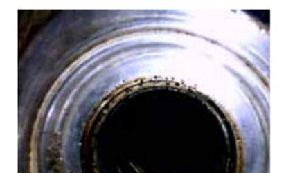
使用6mm长焦镜头(VSA2-1M-w)检查恒温控制阀
