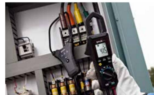
连接TA74柔性电流钳优化测量操作
