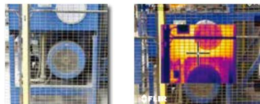
检查电力发动机的运转状态
